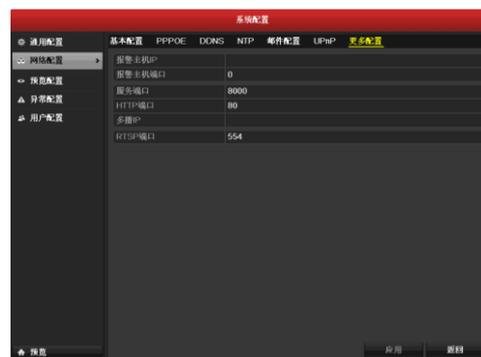
第二步:设置报警主机 IP 及端口号。
