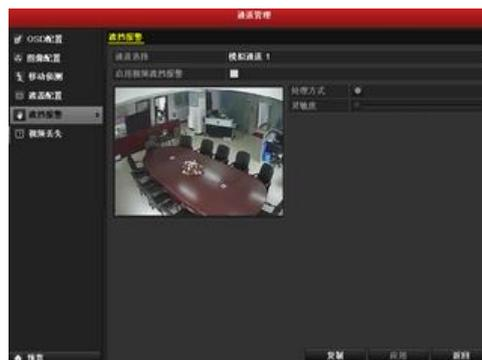
第三步：对该通道视频遮挡报警布防时间段和处理方式进行设置。
